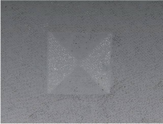
図 16 点群データで表示した一辺 10cm の標定点マーカー。
